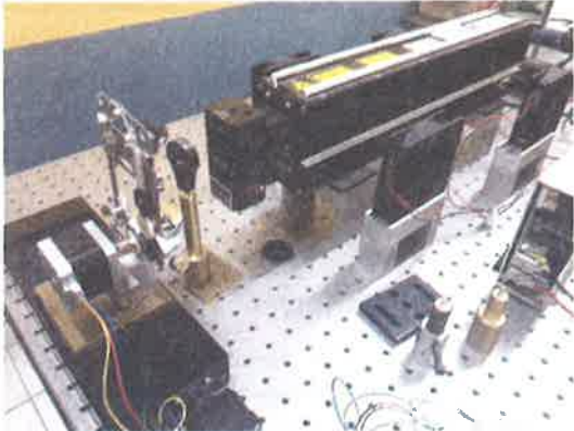
Figura 1. Láser de CO2 y desplazadores micrométricos utilizados para el grabado de las redes LPG.
