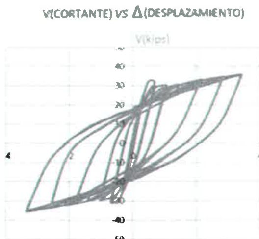
(b) MODELO MULTI-RESORTE CON ELEMENTOS GAP.
