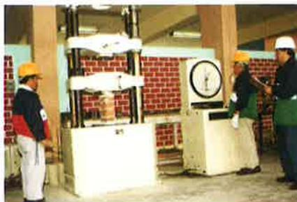
FOTO N°4: ENSAYO DE COMPRESION EN PILAS
