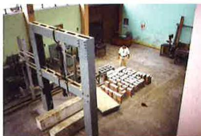
FOTO N°2: ENSAYO DE COMPRESION EN PILAS
