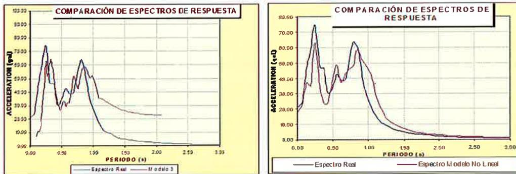
Fig. 2 : Comparación del espectro de respuesta calculado para el modelo más representativo (modelo 3) respecto al espectro de respuesta real, considerando el sismo del 29/03/2008 izquierda: modelo equivalente lineal. Derecha: modelo no lineal
