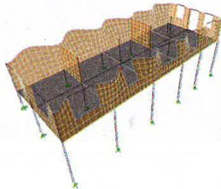
Fig 8. Desplazamiento ocasionado por el sismo (QY) al modelo 1
