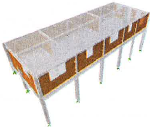
Fig 6. Primer y segundo nivel techados con losa aligerada
