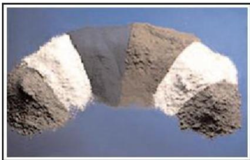
Fig. 1. De derecha a izquierda: Ceniza volante clase C, arcillas activadas térmicamente, micro sílice, ceniza volante clase F, escoria de alto horno y esquistos calcinados (ceniza volante) (Fuente: Ref. Bibliográfica 4)
