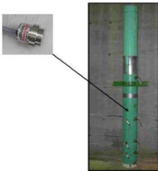
Fig. 4: Columna de PVC ensayada y sensor de presión utilizado.
