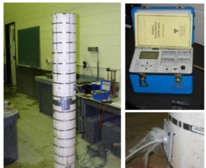
Fig. 2: Prototipo de columna y colocación de sensor.
