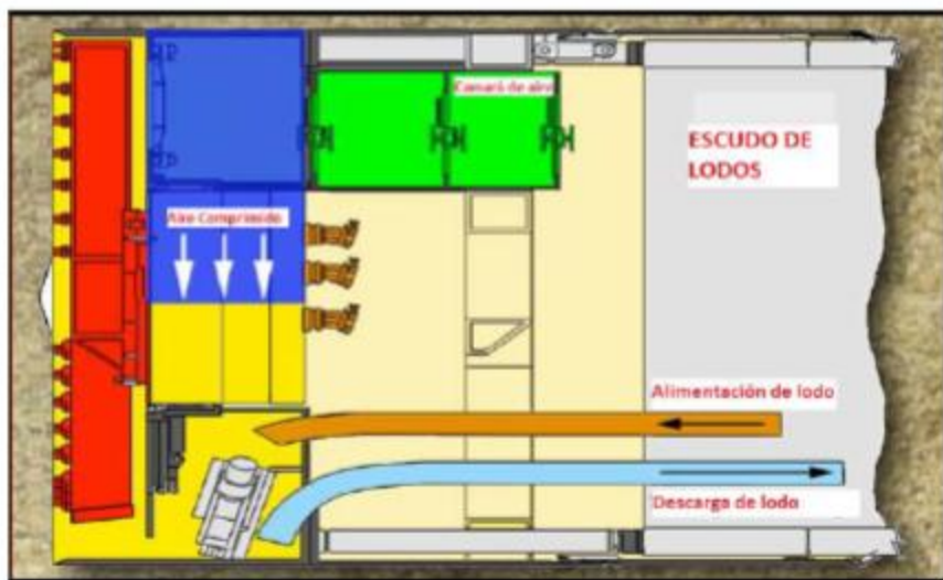
Fig.7. Escudo de Lodos o Hidro-Escudo. III Seminario. Gianfranco Perri, III Seminario Andino de Túneles. Bogotá, 2008
