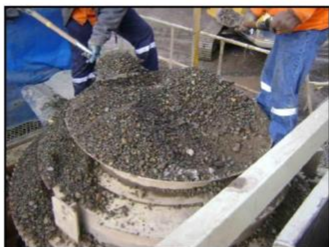
Fig. 9. Sobrellenado de la cámara de chancado por presencia de finos
